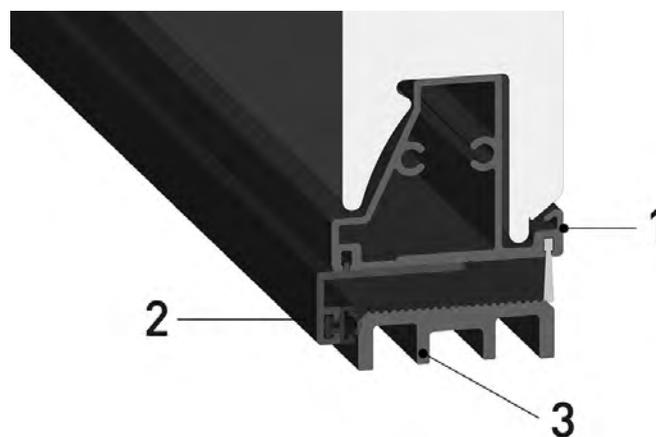
Рис. 7. Нижняя секция двери боковой **SDN-1** в разрезе
